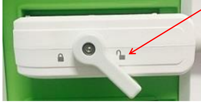
Şekil 11: Kilitsiz Prob Konektörü Kilit Düğmesi
