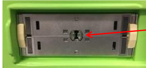
Şekil 9: Prob Konektörü Yuvasındaki Kilit Çentiği
